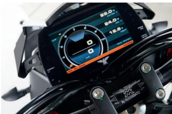
**FORMA CLASSICA, TECNICA MODERNA** Si può cambiare senza tradire le origini. La strumentazione digitale con display TFT da 5" completamente configurabile.
